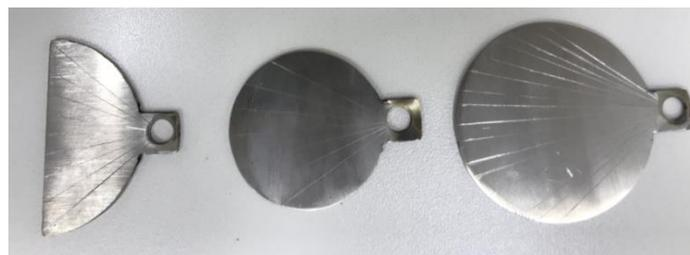
Fig. 15: Templates para leitura em slots de bráquetes.
